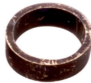
Zerstört durch angriffige Chemikalien aufgrund einer Inkompatibilität verschiedener Additivsysteme in den gemischten Hydraulikflüssigkeiten
